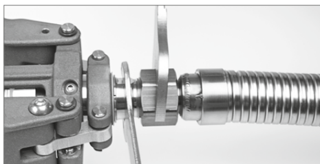
Schlauchleitung an Zapfventil anschrauben. Das vom Hersteller empfohlene Drehmoment von 150 Nm für Schlauchleitungen einhalten. Kein Einsatz von Zangen oder Rohrзangen.
