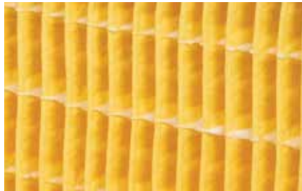
La tecnología E-Pleat moldea el medio filtrante en una serie de canales preformados que dirigen el aire de manera estable a través del filtro, lo que permite una carga más uniforme y una utilización completa del medio filtrante.
