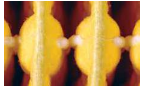
Los cordones adhesivos pegan los pliegues en un paquete rígido.
